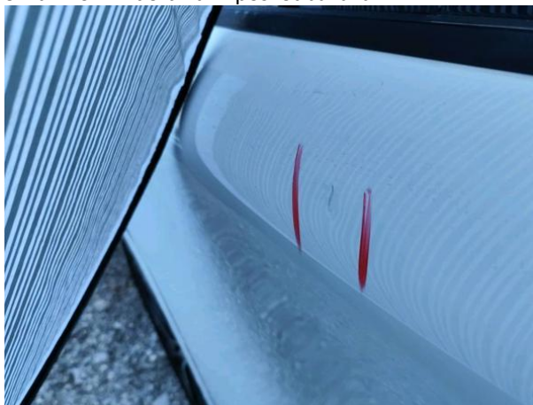
Slika R10-1: Vdolbina in poškodba laka
