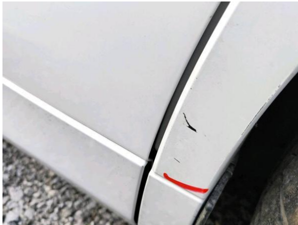
Slika R07-1: Poškodba laka
