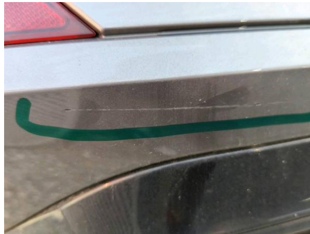
Slika R01-1: Poškodba laka
