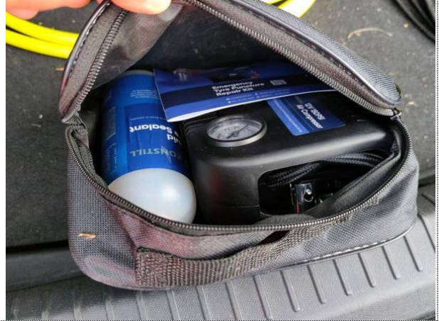
Slika 004: kit za popravilo pnevmatike
