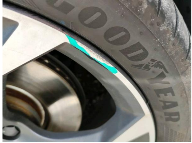
Slika R03-1: Popraskano
