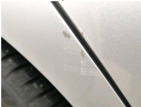
Slika R12-1: Vdolbina in poškodba laka
