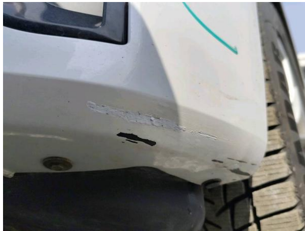
Slika R02-1: Poškodba laka
