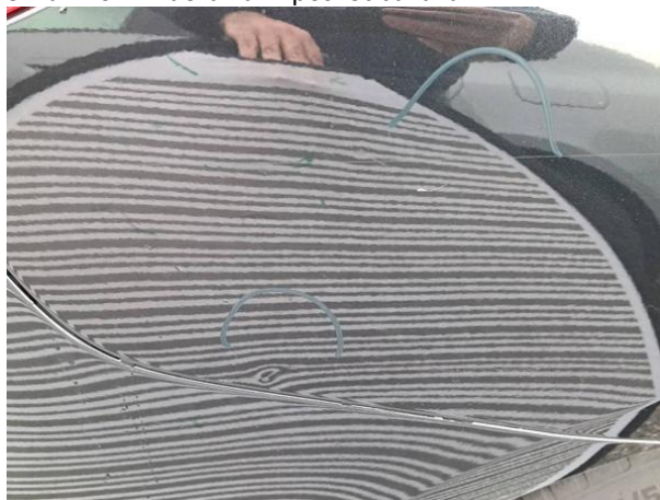
Slika R10-1: Vdolbina in poškodba laka
