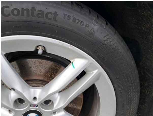
Slika R03-1: Poškodba laka
