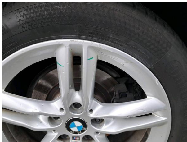
Slika R08-1: Poškodba laka
