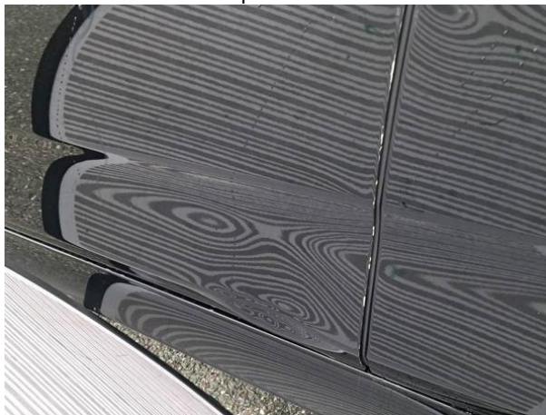
Slika R05-1: Vdolbina in poškodba laka
