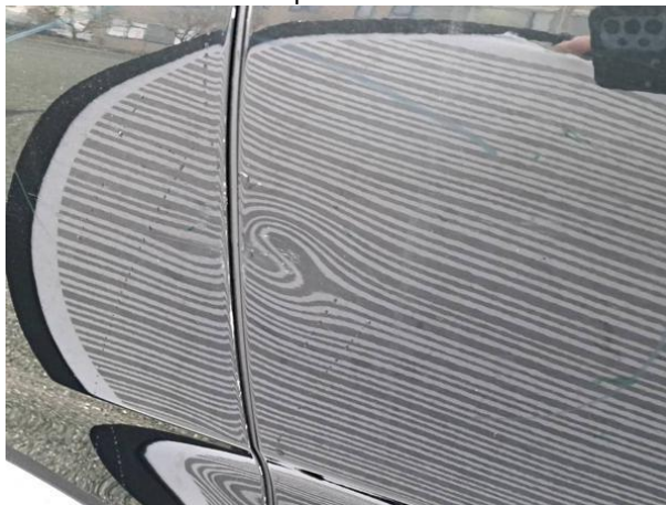
Slika R06-1: Vdolbina in poškodba laka
