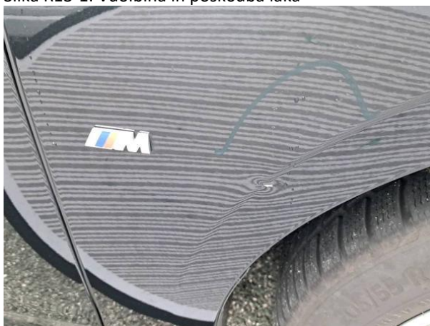
Slika R13-1: Vdolbina in poškodba laka
