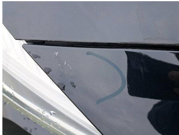
Slika R01-1: Poškodba laka
