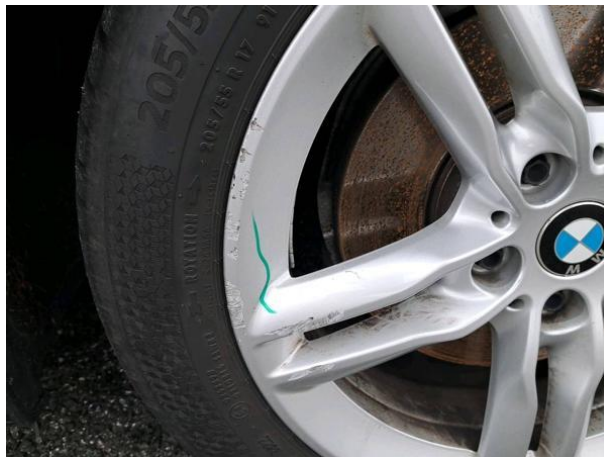
Slika R14-1: Poškodba laka
