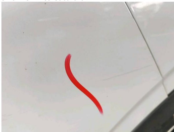
Slika R10-1: Poškodba laka
