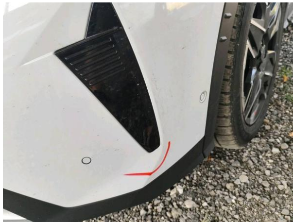
Slika R02-1: Poškodba laka
