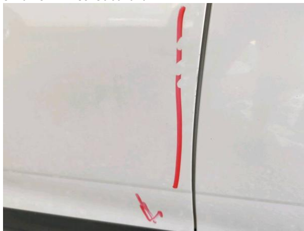
Slika R04-1: Poškodba laka
