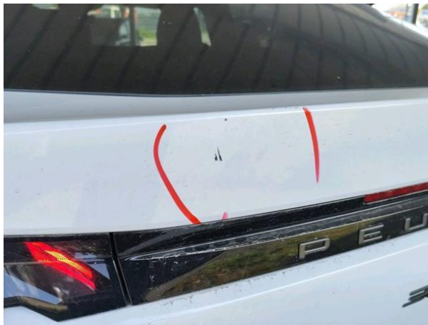
Slika R08-1: Poškodba laka
