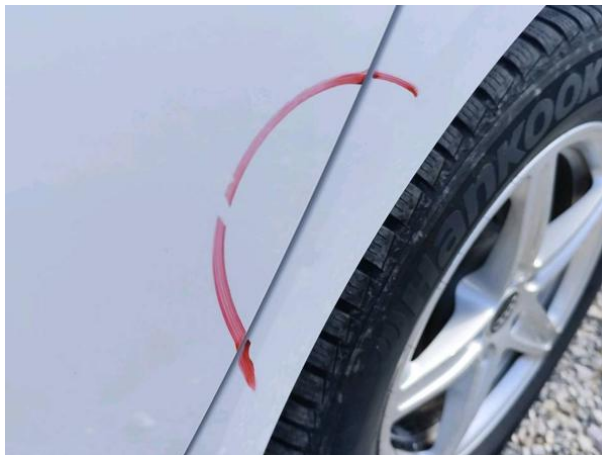
Slika R05-1: Poškodba laka
