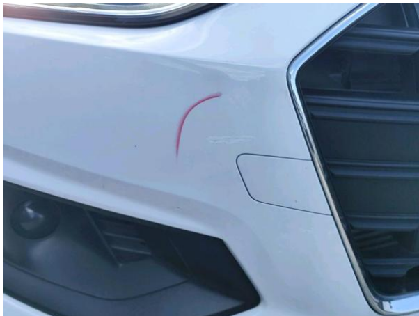
Slika R06-1: Poškodba laka
