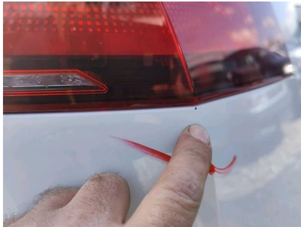
Slika R05-1: Poškodba laka
