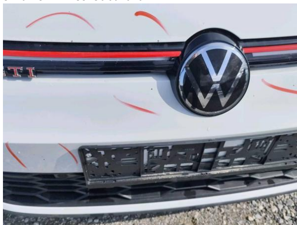
Slika R02-1: Poškodba laka
