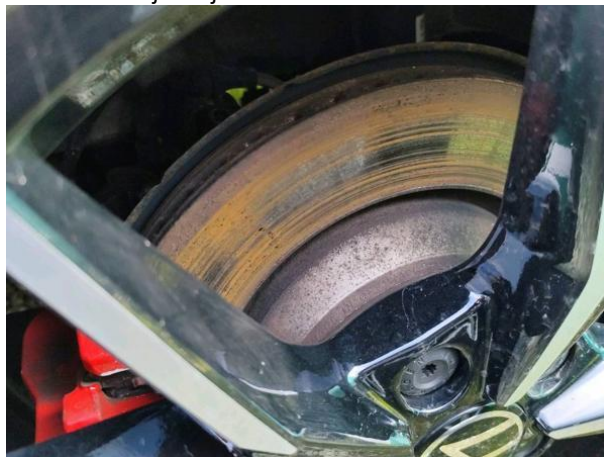
Slika R07-1: Rjavenje zavornih kolutov
