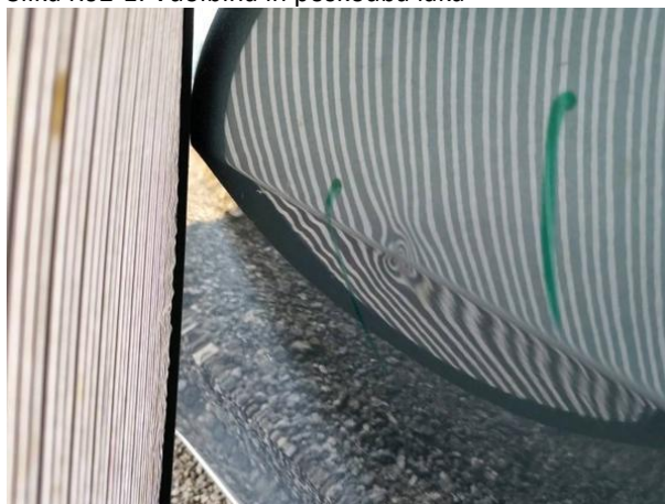
Slika R02-1: Vdolbina in poškodba laka
