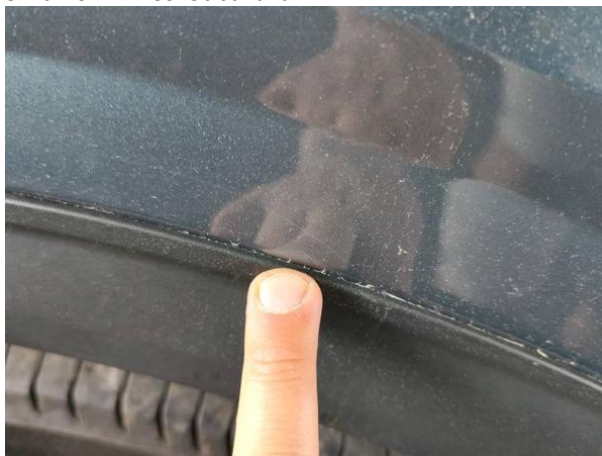
Slika R04-1: Poškodba laka
