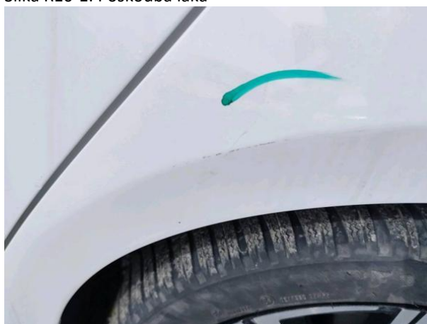
Slika R10-1: Poškodba laka
