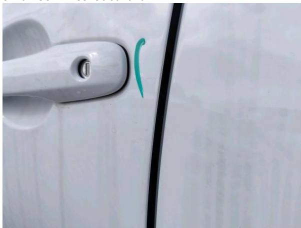
Slika R06-1: Poškodba laka
