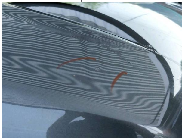
Slika R02-1: Vdolbina in poškodba laka
