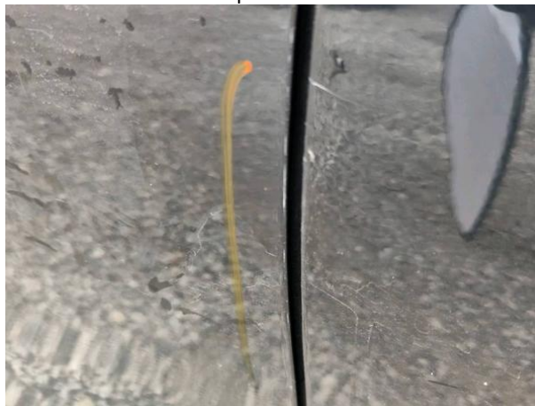
Slika R05-1: Vdolbina in poškodba laka
