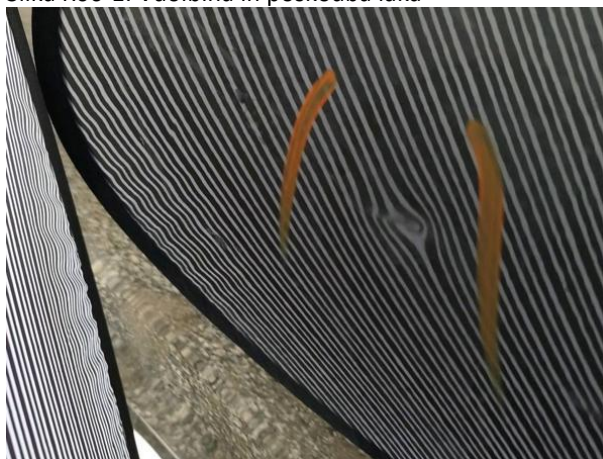
Slika R06-1: Vdolbina in poškodba laka
