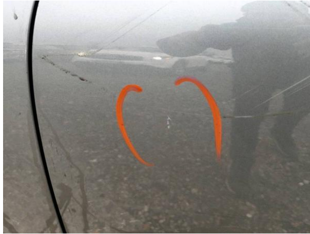
Slika R10-1: Poškodba laka
