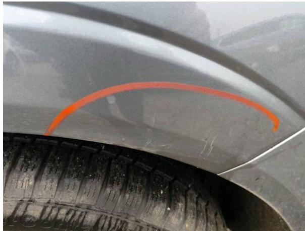
Slika R08-1: Poškodba laka
