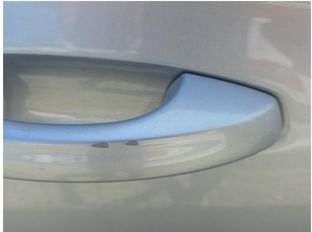
Slika R09-1: Poškodba laka
