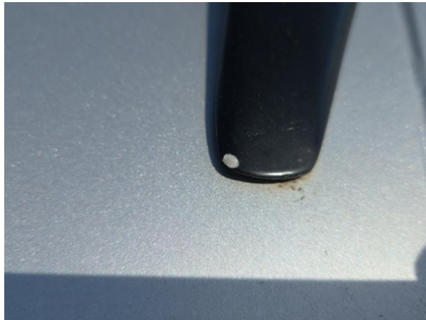
Slika R20-1: Poškodba laka
