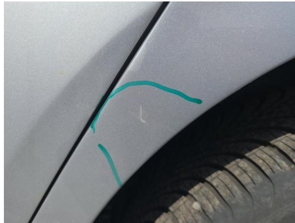
Slika R11-1: Poškodba laka
