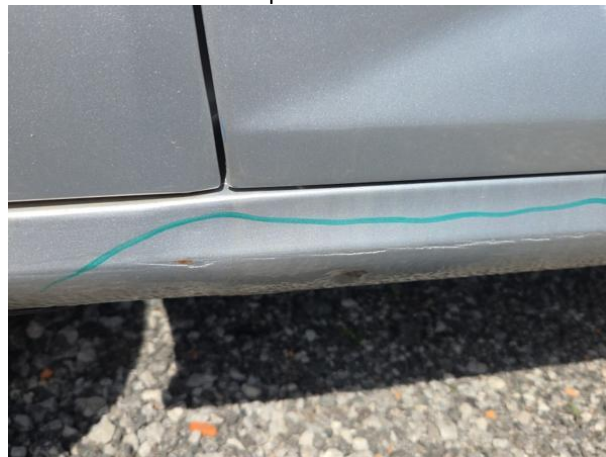
Slika R17-1: Vdolbina in poškodba laka
