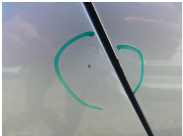
Slika R10-1: Poškodba laka
