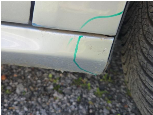
Slika R05-1: Poškodba laka
