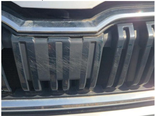
Slika R04-1: Popraskano
