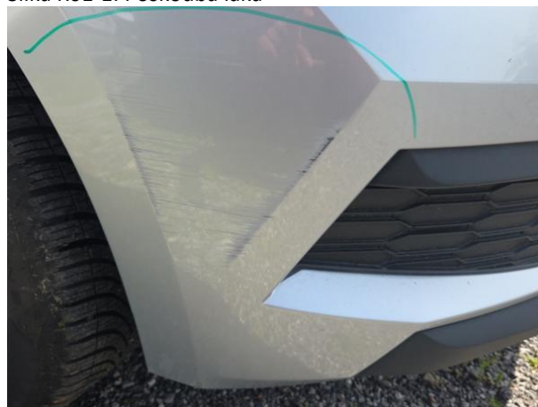
Slika R01-1: Poškodba laka
