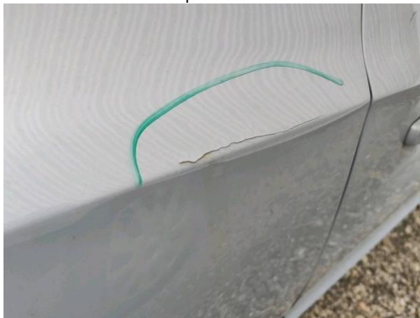
Slika R14-1: Vdolbina in poškodba laka
