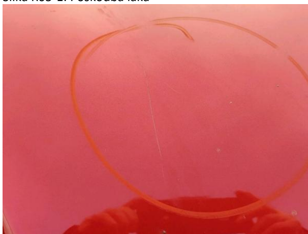
Slika R05-1: Poškodba laka
