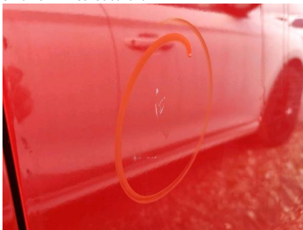
Slika R04-1: Poškodba laka
