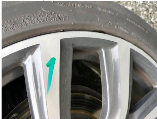
Slika R14-1: Popraskano
