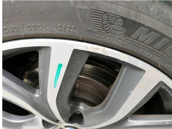
Slika R13-1: Popraskano
