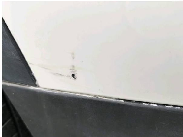
Slika R12-1: Poškodba laka
