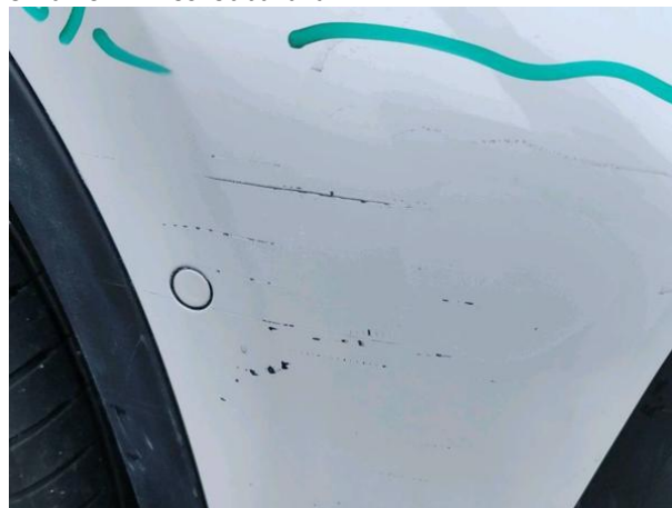
Slika R04-1: Poškodba laka
