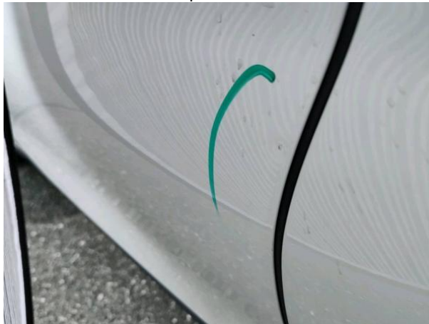
Slika R08-1: Vdolbina in poškodba laka
