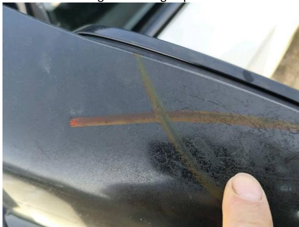
Slika R08-1: Neoriginalni obloga - poškodba
