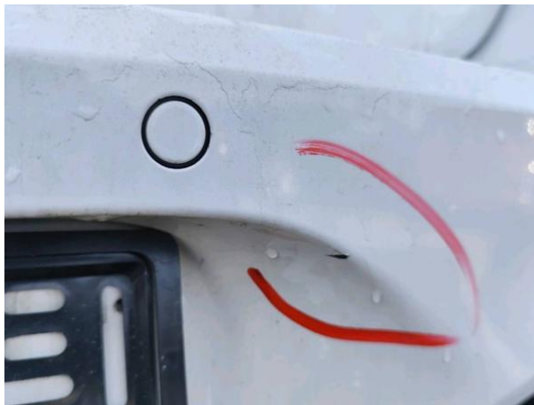
Slika R06-1: Poškodba laka
