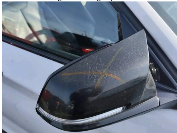
Slika R03-1: Neoriginalna obloga - poškodba
