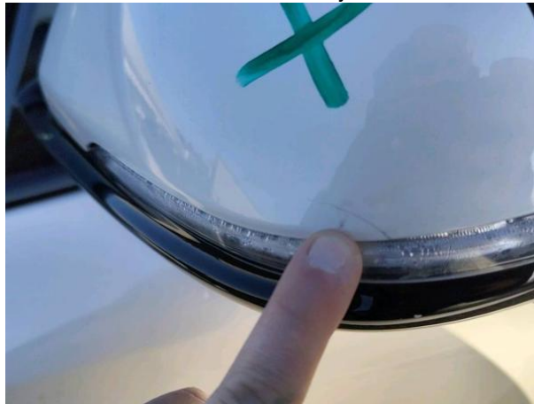
Slika R04-1: Poškodba laka in zlomljen smernik
