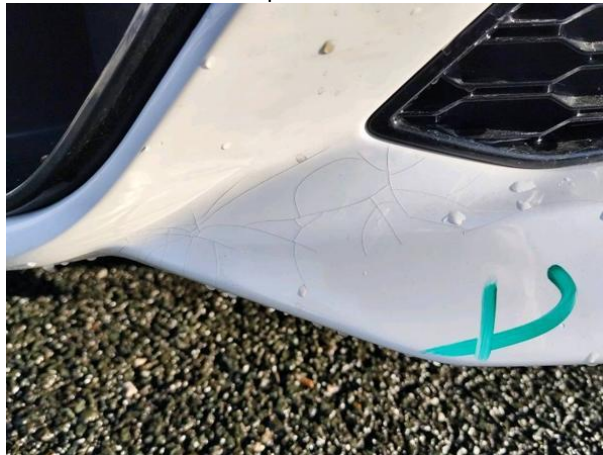
Slika R02-1: Izboklina in poškodba laka
