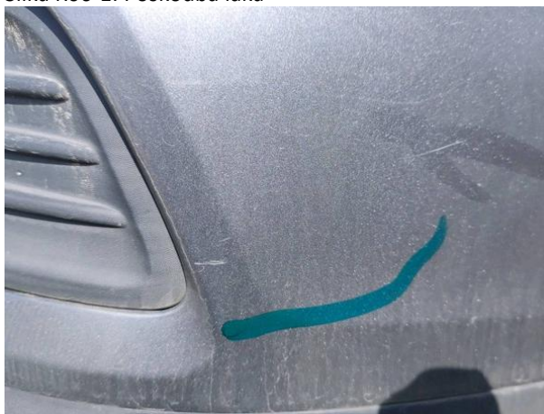
Slika R06-1: Poškodba laka
