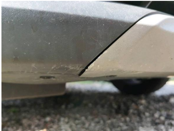
Slika R10-1: Poškodba laka
