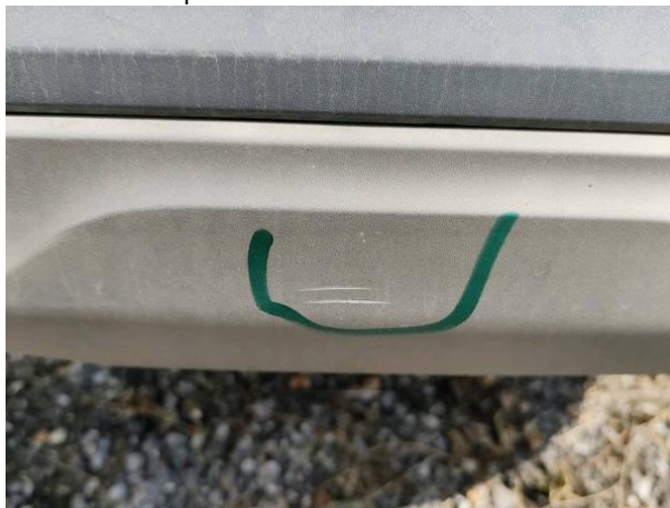
Slika R05-1: Popraskano
