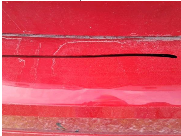
Slika R06-1: Vdolbina in poškodba laka
