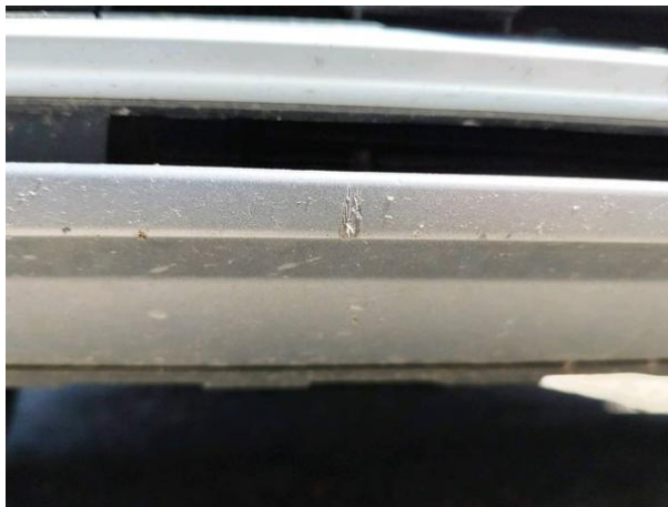
Slika R09-1: Poškodba laka
