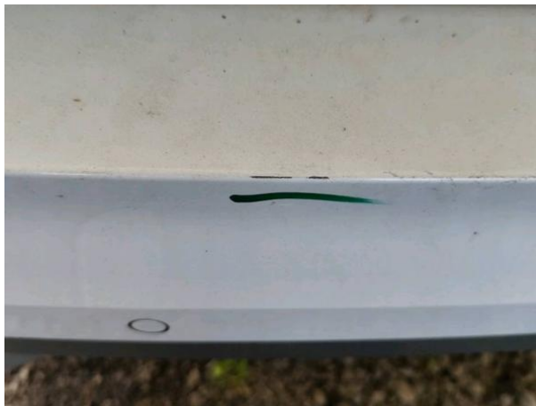
Slika R08-1: Poškodba laka
