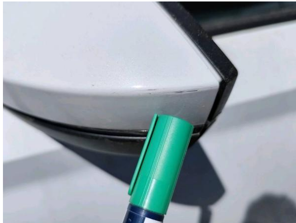
Slika R04-1: Poškodba laka
