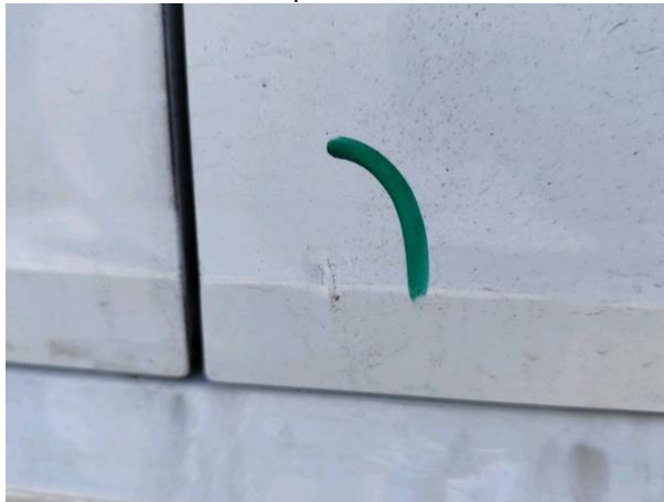
Slika R05-1: Vdolbina in poškodba laka
