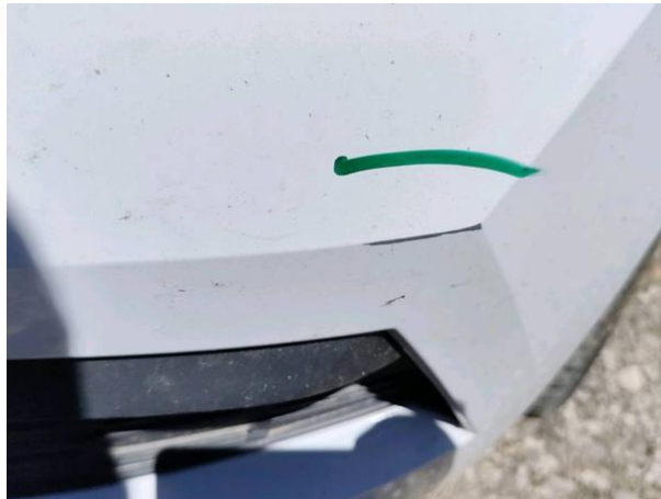
Slika R02-1: Poškodba laka
