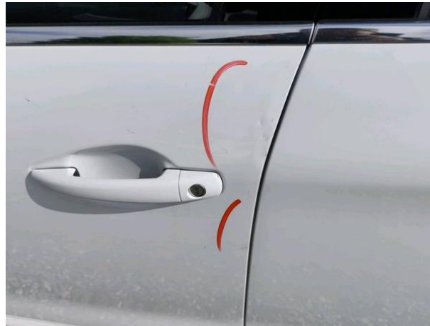
Slika R08-1: Poškodba
