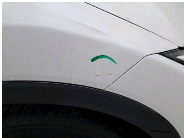
Slika R13-1: Poškodba laka
