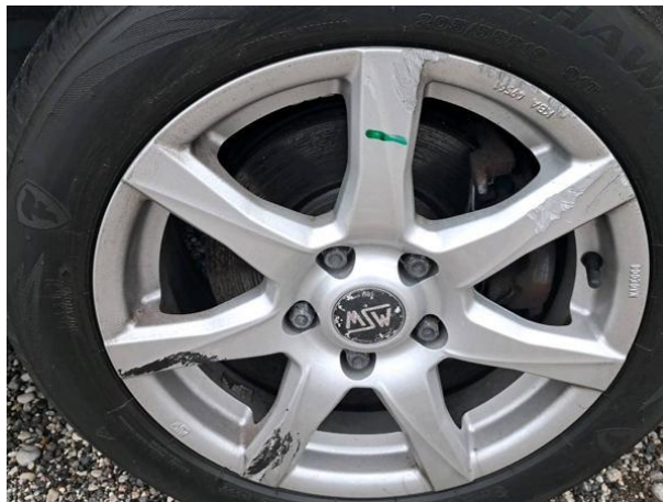
Slika R15-1: Poškodba
