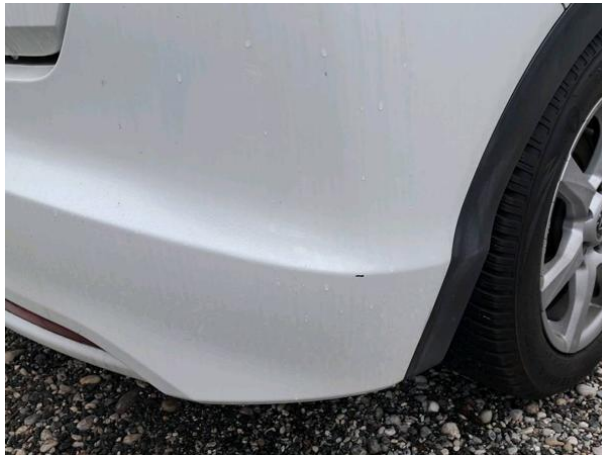
Slika R09-1: Poškodba laka
