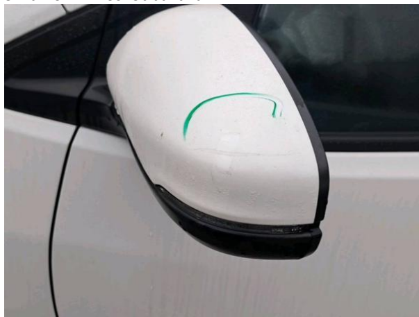
Slika R04-1: Poškodba laka
