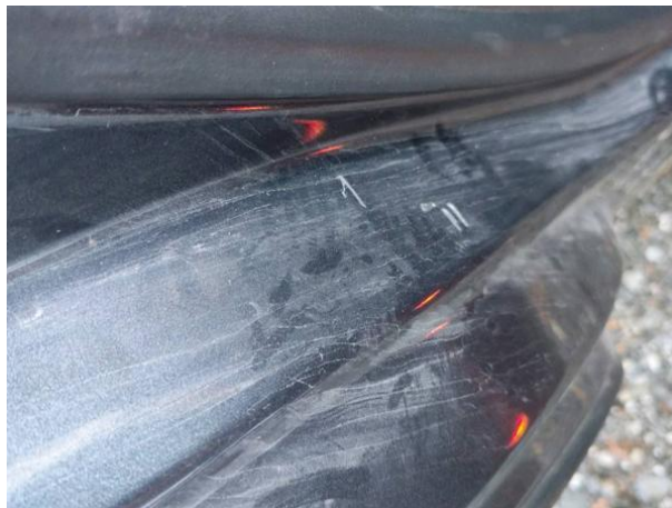
Slika R02-1: Poškodba laka
