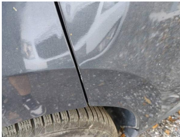
Slika R16-1: Poškodba laka
