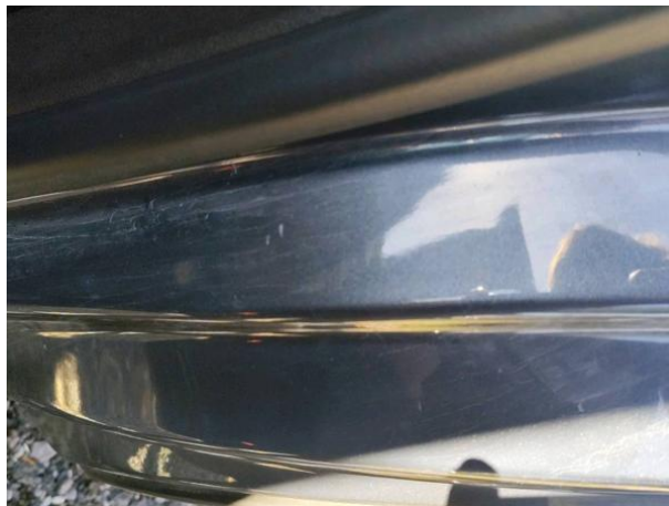
Slika R01-1: Poškodba laka
