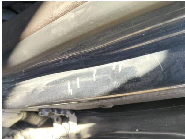
Slika R03-1: Poškodba laka
