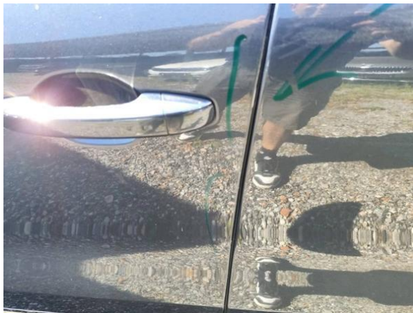
Slika R25-1: Poškodba laka
