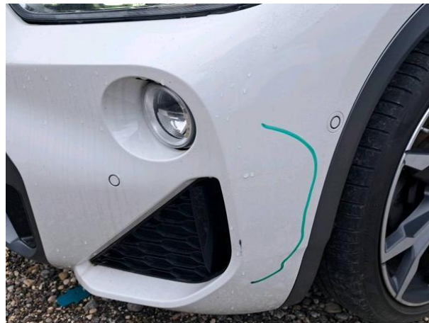
Slika R01-1: Poškodba laka
