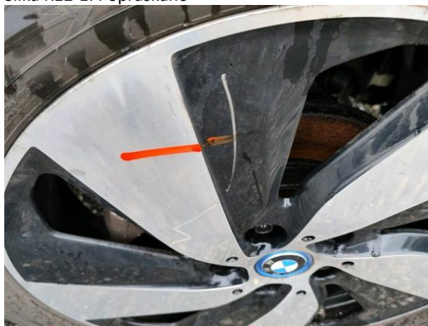
Slika R12-1: Popraskano
