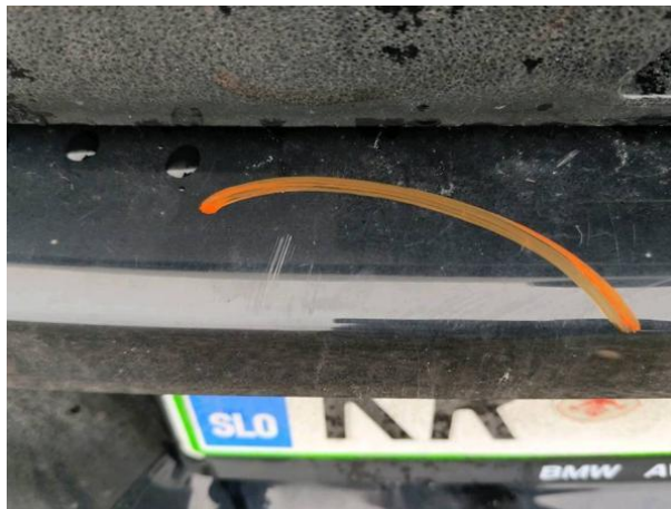
Slika R09-1: Poškodba laka
