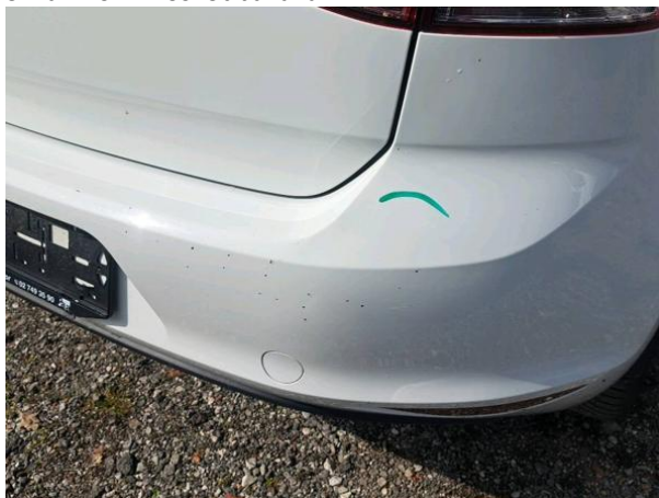
Slika R10-1: Poškodba laka
