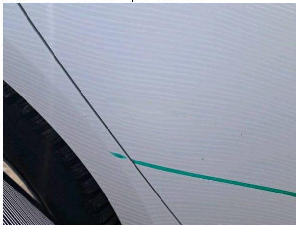
Slika R13-1: Vdolbina in poškodba laka
