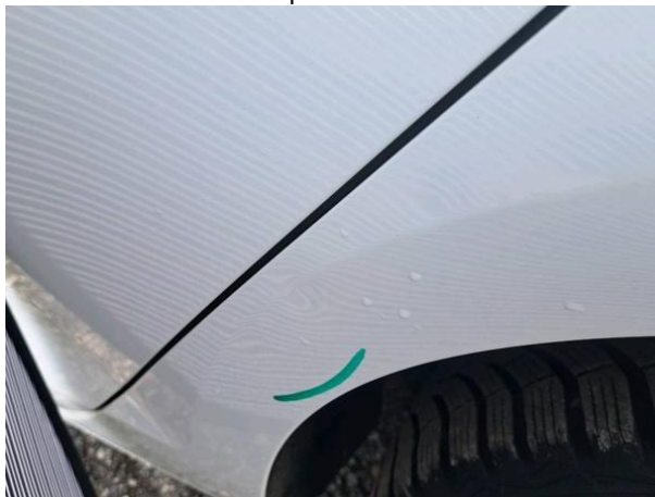
Slika R09-1: Vdolbina in poškodba laka
