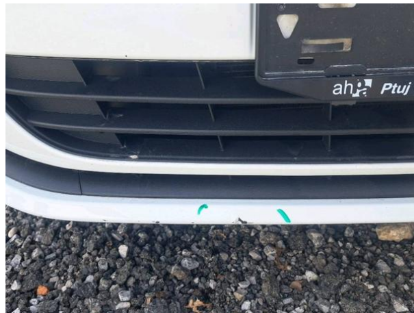
Slika R02-1: Poškodba laka
