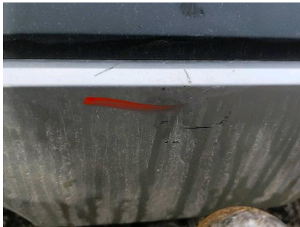
Slika R08-1: Poškodba laka
