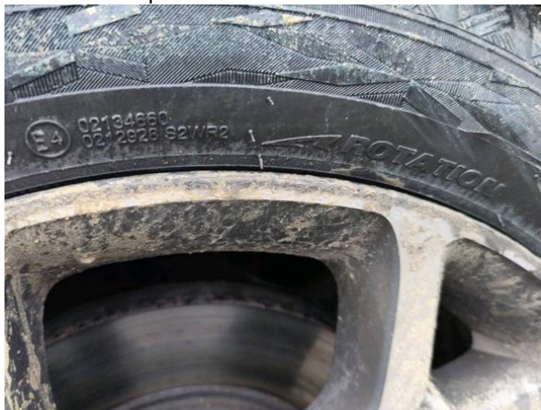
Slika R06-1: Popraskano
