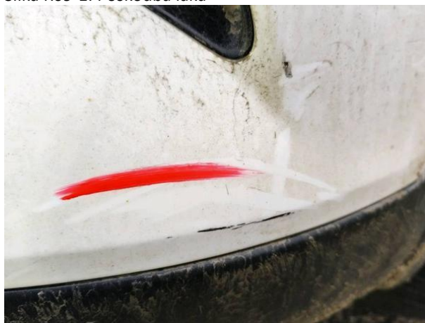
Slika R09-1: Poškodba laka
