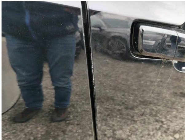
Slika R02-1: Poškodba laka
