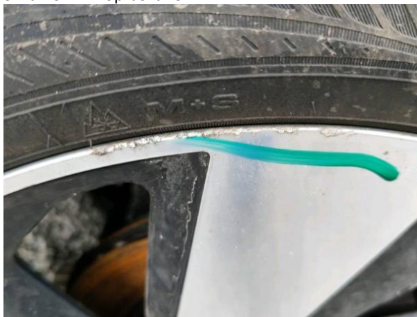
Slika R04-1: Popraskano
