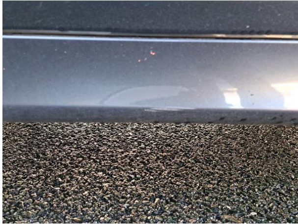
Slika R05-1: Poškodba laka
