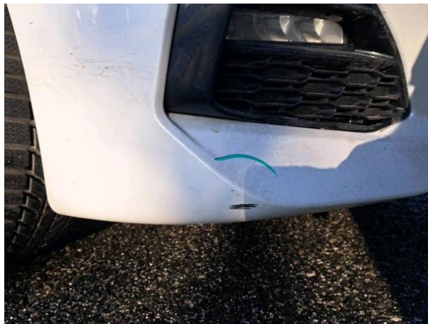
Slika R01-1: Poškodba laka
