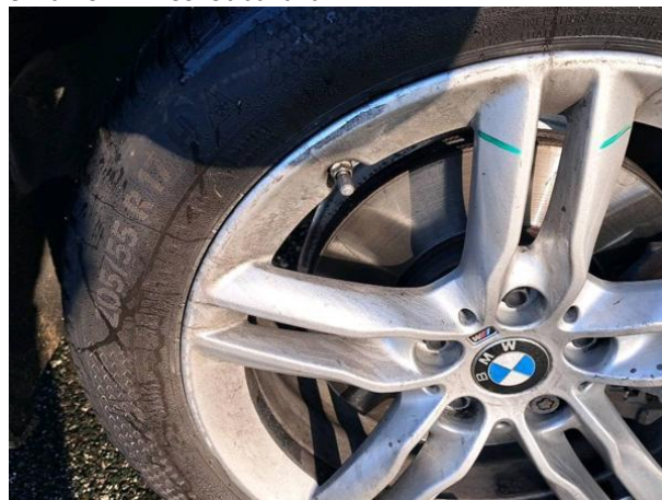
Slika R07-1: Poškodba laka
